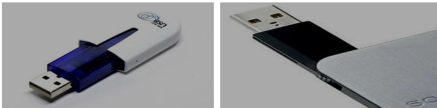
Şəkil . Flaş-yaddaş modulu və onun qoşulması
