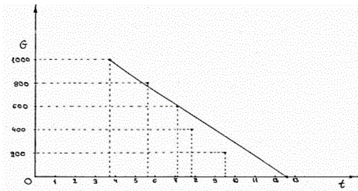
Şəkil 8. Duzun kütləsindən G asılı olaraq südün soyuma temperaturasının t dəyişmə qrafiki
