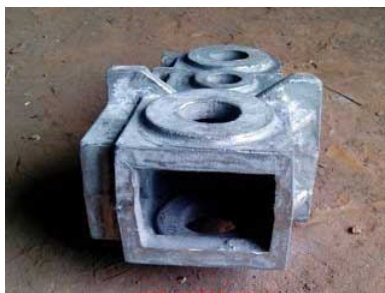
Şəkil 10. FET əlavə edilmiş qəlibdə hazırlanmış çuqun tökük (çəkisi 150 kq)
