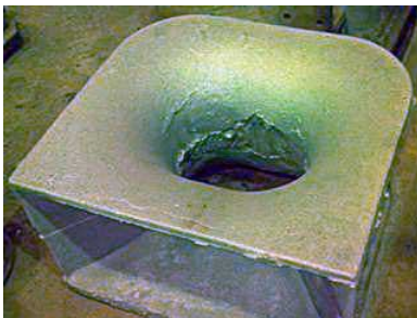
Şəkil 9. NET əlavə edilmiş qəlibdə hazırlanmış çuqun tökük (çəkisi 60 kq)
