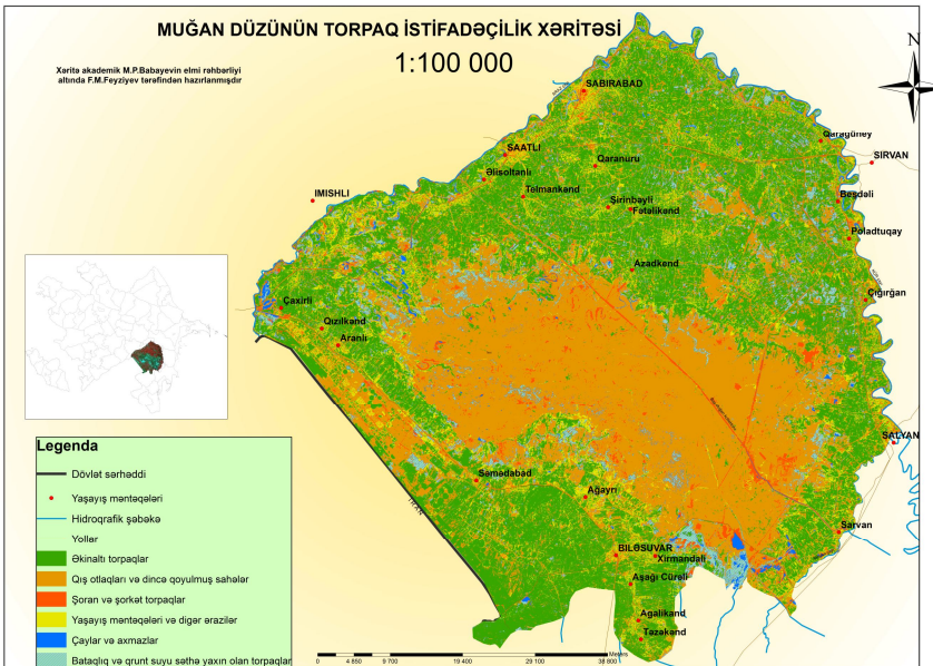
Şək. 4. Muğan düzünün yaxın İQ, orta İQ və göy (0.76-0.90, 0.63-0.69, 0.52-0.60 mm) kanal kombinasiyalarından istifadə olunaraq hazırlanan torpaq istifadəçiliyi xəritəsi
