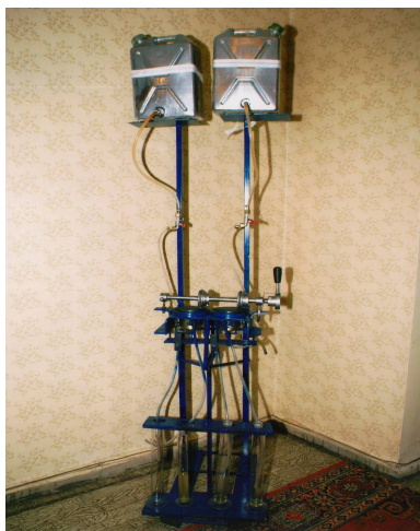
Şək.2. Müxtəlif qatılığa malik duzlu məhlulların dozalaşdırılması üçün qurğunun ümumi görünüşü.
