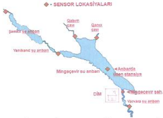
Şək. 2. Mingəçevir su anbarı və onu əhatə edən regionda suyun səviyyəsinə nəzarət edən avtomatlaşdırılmış informasiya-ölçmə sisteminin vacib sensor lokasiyalarının regional sxemi.
