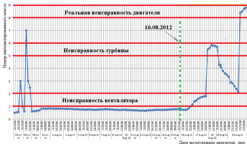
Рис. 2 Распознавание текущего состояния двигателя CF6-80C2 (с/н 707215) на основе статической нейромодели
