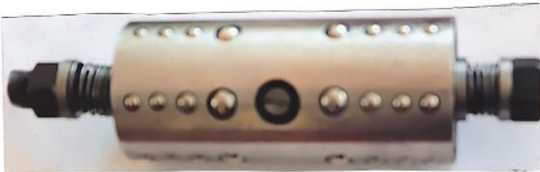
Şəkil 7. Nazik divarlı qeyri sərt detalların daxili səthlərinin emalı üçün döyənəkləmə başlığı. Müəlliflik şəhadətnaməsi № İ20120090.
